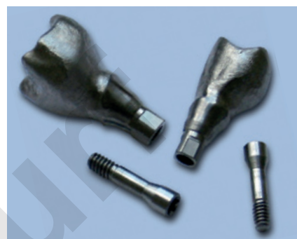
Abb. 7: Abutments nach der Bearbeitung in der Fräsmaschine.
