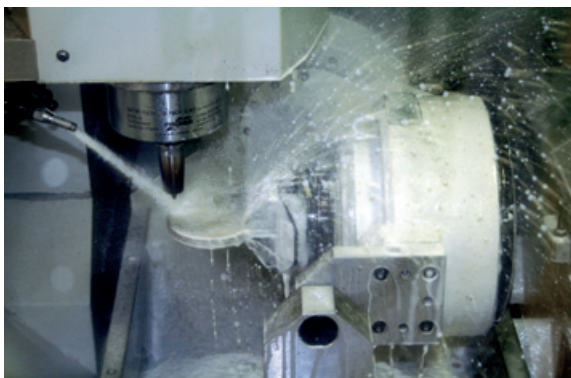
Abb. 6: HSC-Fräsen von Titan in der Fräsmaschine RXP 500 DSC von Röders.
